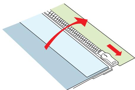
Abaissez le pied sur le dessus de la fermeture, en bas, afin que l'aiguille pique le tissu à côté du pli et du ruban de fermeture.
