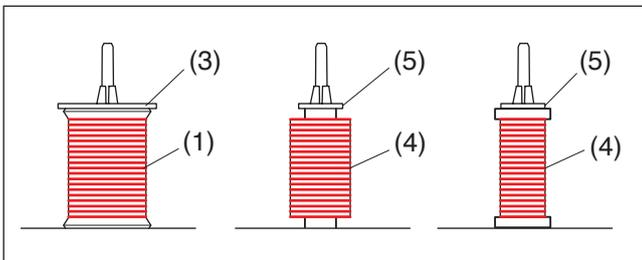
Utilisez le support de bobine (grand) pour les bobines ordinaires et le support de bobine (petit) pour les petites bobines.
