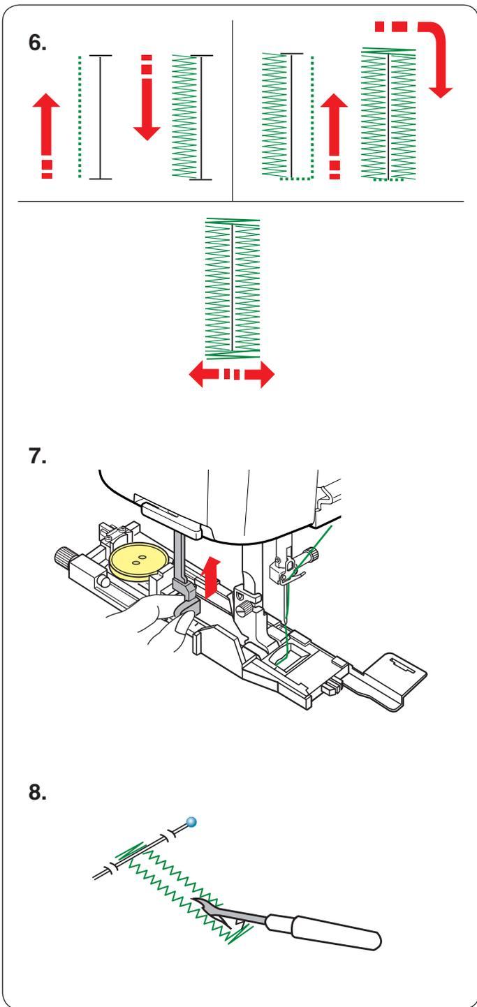
6. La boutonnière sera cousue automatiquement en suivant la procédure indiquée. Lorsque la boutonnière est terminée, la machine s'arrête automatiquement avec l'aiguille en position haute. Appuyez sur la touche du coupe-fil et retirez le tissu.
