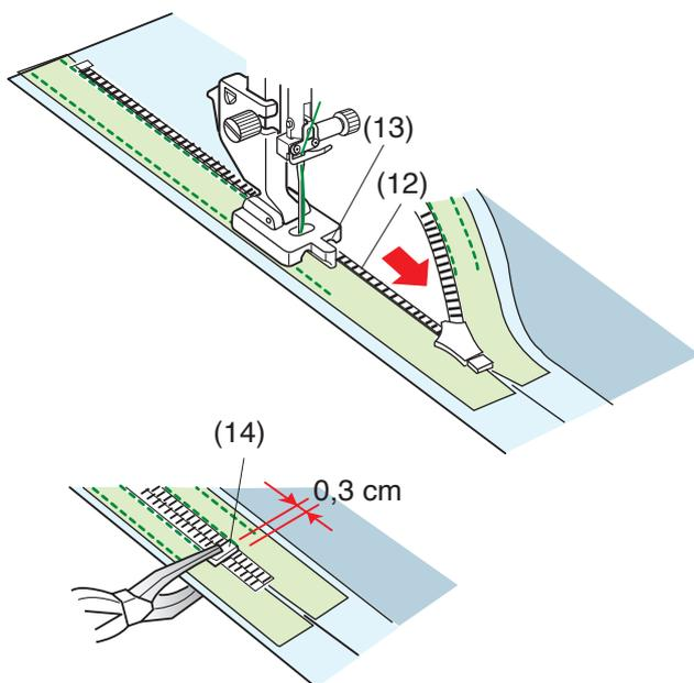
Relevez les dents de la fermeture éclair sur la gauche et abaissez le pied de sorte que la rainure droite du pied capture les dents de la fermeture éclair.
