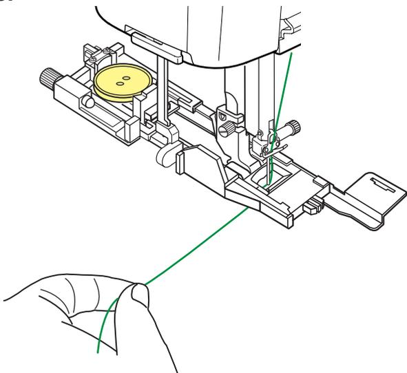
3. Faites passer le fil d'aiguille à travers le trou du pied en tirant vers la gauche.
