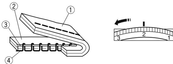
Positionnez la molette de tension du fil sur un nombre inférieur pour diminuer la tension du fil.
