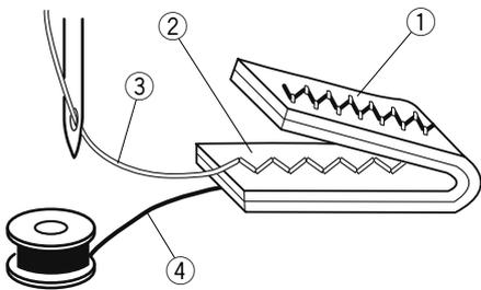
Dans le cas d'un point zigzag, le fil d'aiguille ressort légèrement sur l'envers du tissu.
