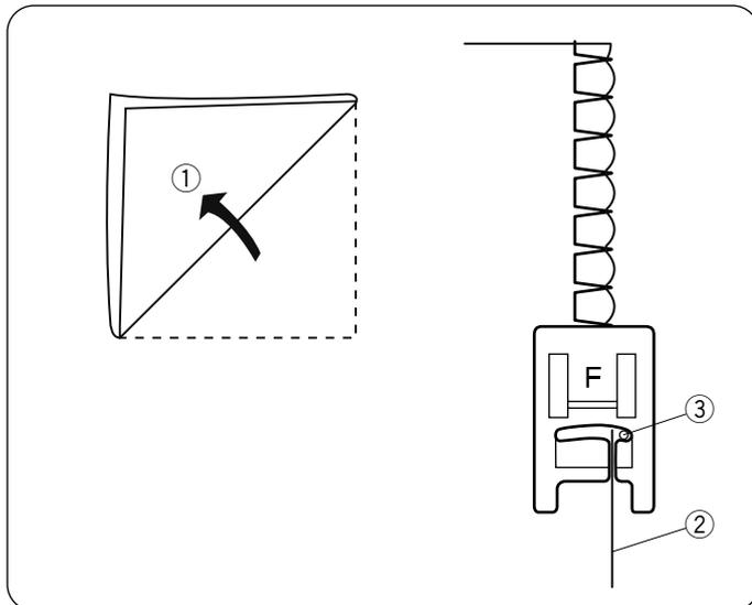
Utilisez un tissu léger (par exemple du tricot). Pliez le tissu comme indiqué sur le schéma, puis piquez sur le pli. Laissez l'aiguille effleurer le bord plié pour créer une bordure festonnée. Il se peut que vous deviez augmenter la tension du fil de l'aiguille.
