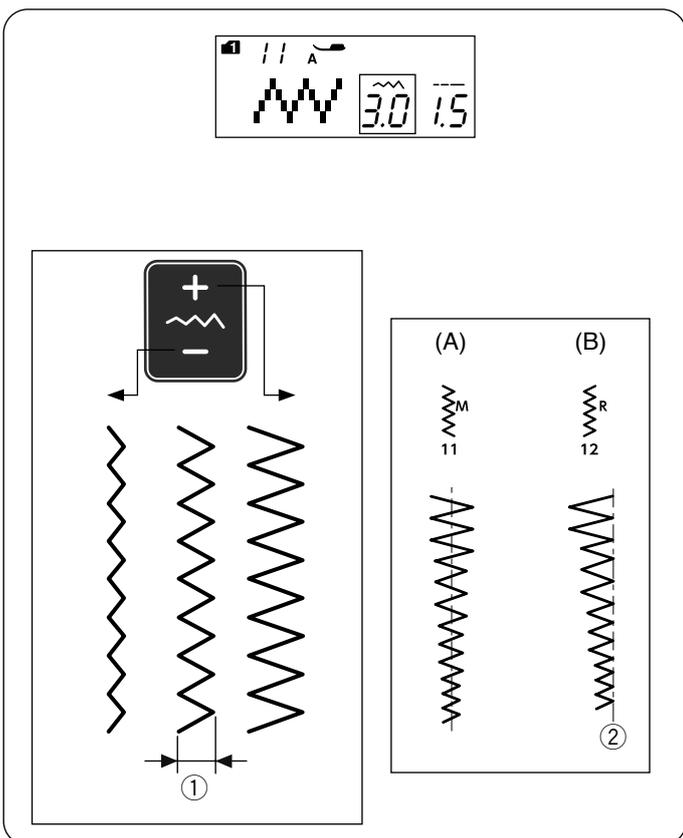
(A): Le motif numéro 11 (mode 1) a une position fixe de piqûre de l'aiguille au centre. La largeur du point varie de manière symétrique.
