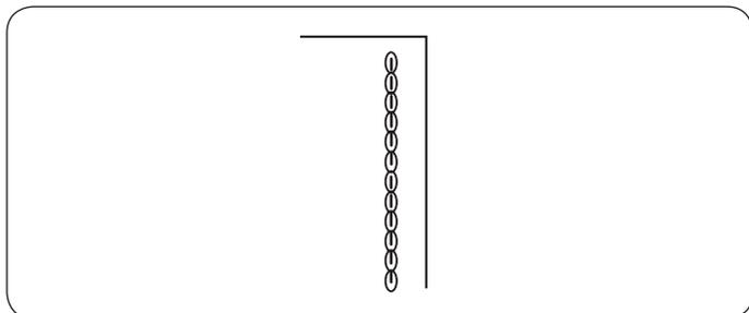
Ce point solide et durable est conseillé pour les travaux exigeant élasticité et solidité afin d'assurer confort et durabilité. Vous pouvez ainsi l'utiliser pour renforcer des endroits tels que les emmanchures et les entrejambes. Vous pouvez également l'utiliser pour confectionner des articles tels que des sacs à dos afin de leur conférer davantage de solidité.
