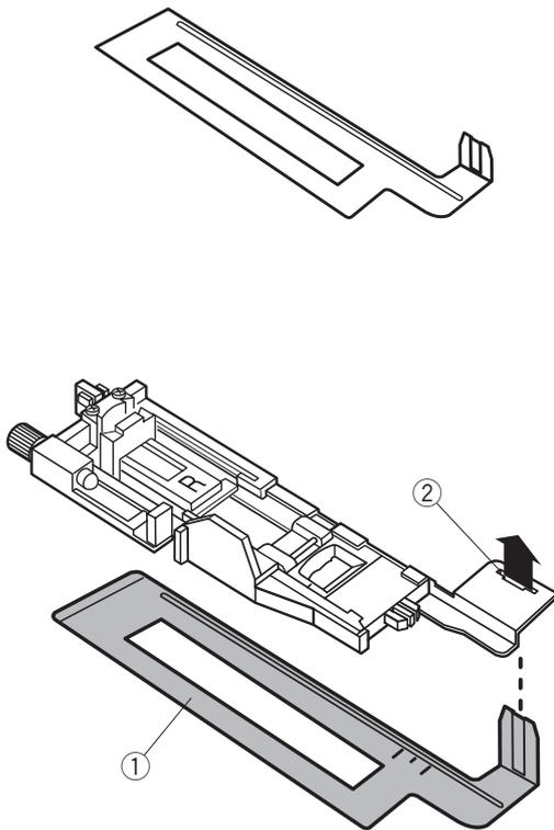
1 Insérez l'onglet de la plaque de stabilisation ① dans l'encoche ② du pied pour boutonnière.
