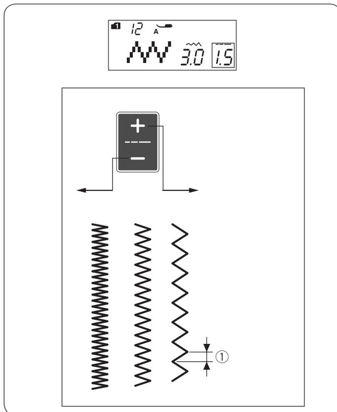
Le point zigzag peut s'utiliser pour diverses applications, dont le surfilage. Il peut être utilisé avec la plupart des étoffes tissées.
