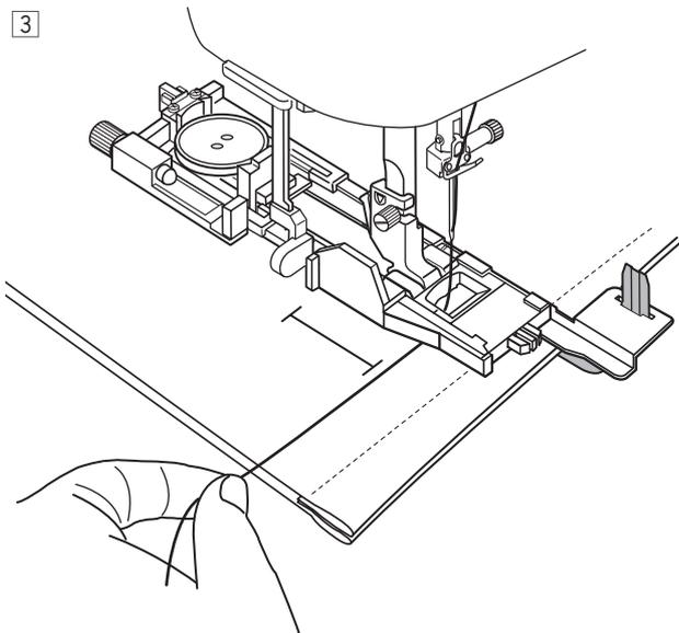
3 Insérez le tissu entre le pied pour boutonnière et la plaque de stabilisation. Abaissez l'aiguille à l'emplacement où vous souhaitez commencer en tournant le volant. Abaissez le levier du pied et de la boutonnière. Démarrez la machine.
