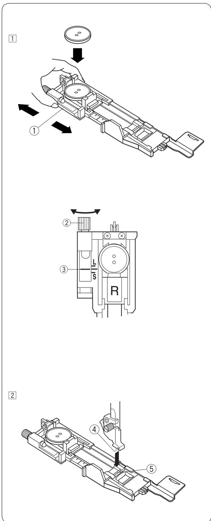
La dimension de la boutonnière est automatiquement déterminée lorsque vous placez le bouton à l'arrière du pied pour boutonnière automatique R.
