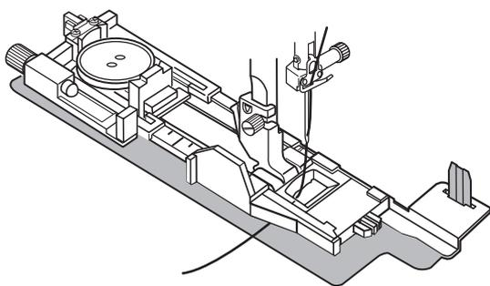
2 Placez le bouton sur le porte-bouton situé sur le pied. Fixez le pied pour boutonnière à la machine. Appuyez deux fois sur la touche de position haute/basse de l'aiguille puis déplacez le tissu sur la gauche afin d'amener les fils de l'aiguille et de la canette entre le pied et la plaque de stabilisation.
