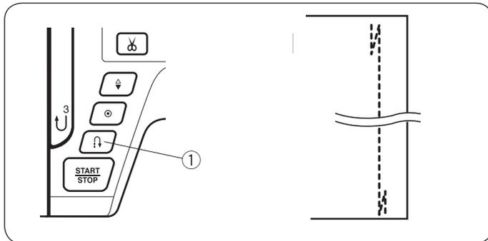
Ce point sert à consolider le début et la fin d'une couture avec le point arrière. Lorsque vous atteignez l'extrémité d'une couture, appuyez une fois sur le bouton de point arrière ①. La machine coud alors quatre points en marche arrière, quatre points en marche avant, avant de s'arrêter de coudre automatiquement.
