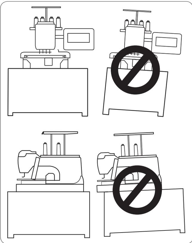
Prévoyez un dégagement suffisant autour de la machine pour permettre le libre mouvement du cadre à broder.
