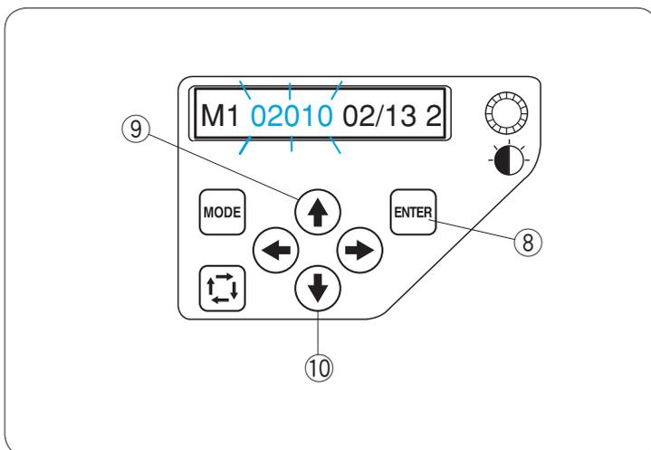
Si le fil casse ou vient à manquer en cours de broderie, la machine s'arrête automatiquement et le cadre à broder revient à la position où le fil a cassé ou s'est terminé. Cependant, vous pouvez ajuster avec précision la position de redémarrage en déplaçant le cadre.
