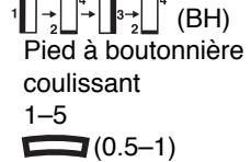
Coloque la perilla de longitud de puntada entre 0.25 y 1.0 para ajustar la densidad de la puntada para ojales.
