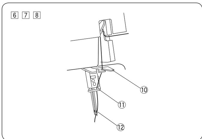
6 Passez le fil à travers la fente droite du guide-fil d'aiguille.
