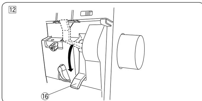
12 Baissez le levier d'enfilage du boucleur jusqu'à ce qu'il s'enclenche en place.
