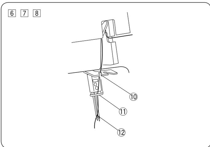
6 Passez le fil à travers la fente gauche du guide-fil d'aiguille.
