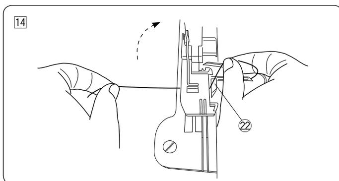
14 Tirez 10 cm (4") du fil situé sous l'extrémité du pied et tirez-le vers l'arrière entre le pied et le couteau supérieur.
