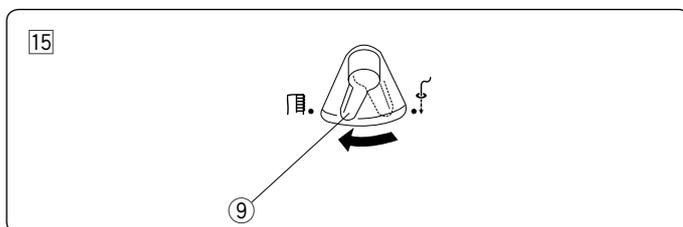
15 Ramenez le levier de commutation d'enfilage inférieur en position « SEWING ».
