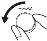
2 Mettez la molette de réglage de la largeur du point pour ajuster la largeur du point sur « 3,5 ».
