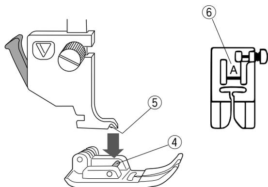
Placez le pied souhaité sous le support de pied, de façon à ce que la charnière du pied soit positionnée au-dessous de l'échancrure du porte-pied.
