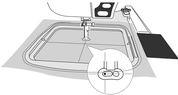
Ajustez la position du cadre avec les touches de déplacement, de façon à ce que la position de l'aiguille se trouve juste au-dessus du centre des lignes de centrage sur le tissu.
