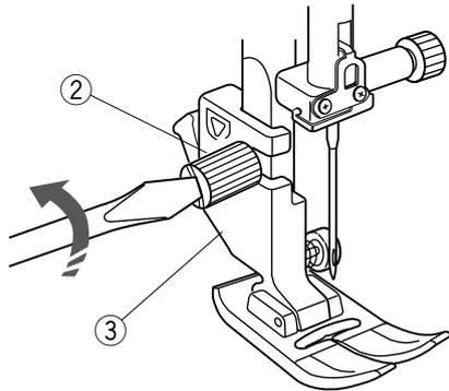
Desserrez la vis moletée à l'aide du tournevis et retirez le porte-pied.
