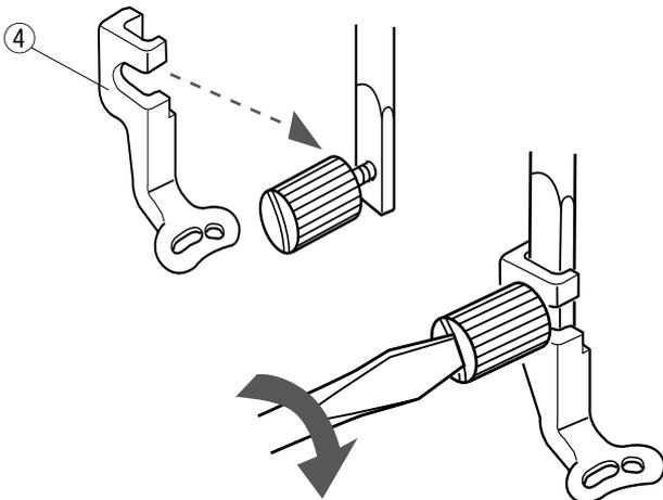
Fixez le pied de broderie P à la barre d'appui par derrière.
