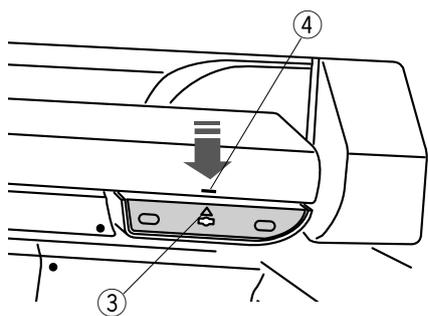
Faites basculer le bras du chariot jusqu'à ce qu'il soit complètement verrouillé en position déployée.
