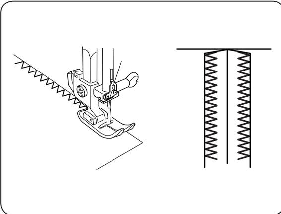
Le point zigzag large est utilisé sur le rentré de couture pour éviter que le tissu ne s'effiloche sur les bords bruts.
