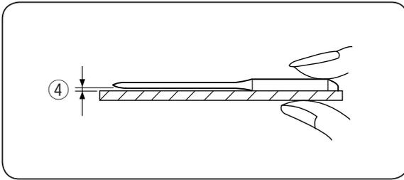
Pour vérifier si une aiguille est droite, placez le côté plat de l'aiguille sur une surface plane (plaque à aiguille, miroir etc.). L'écartement entre l'aiguille et la surface plane doit être le même partout. N'utilisez jamais une aiguille émoussée.
