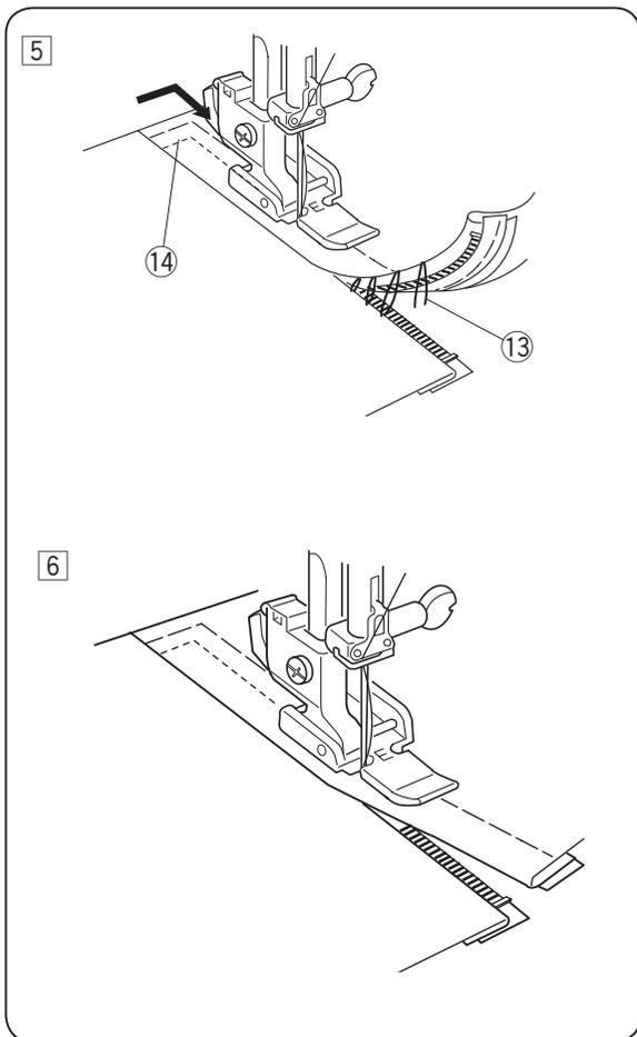
5 Soulevez et relâchez le pied-de-biche, et réinstallez le pied avec la charnière gauche. En débutant juste sous l'arrêt du bas de la fermeture, piquez le tissu à environ 1 cm de distance de la ligne de faufilage.
