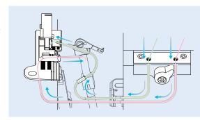
lorsque le levier atteint la base. Ce système d'enfilage pneumatique crée des conditions optimales pour obtenir un enfilage à jet d'air fiable.
