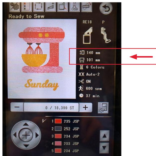
Divisez la hauteur (140mm) en deux pour déterminer le centre. Dans notre échantillon, le centre du motif est à 70mm à partir du bord supérieur ou inférieur du motif.
