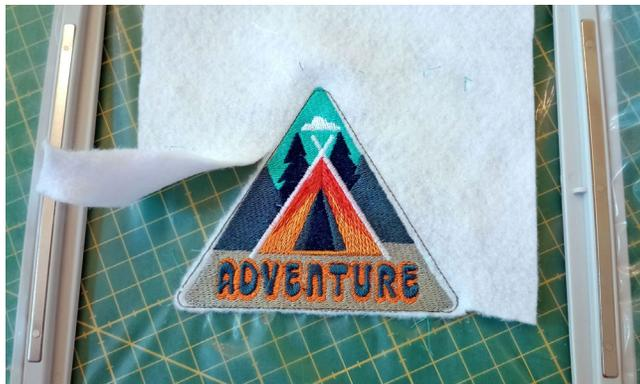
Remplacez le cerceau sur la machine et renfilez-la pour broder la bordure.
